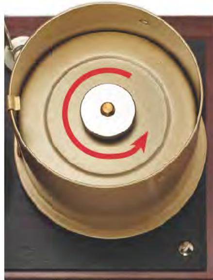
Dévisser l'écrou de blocage du cylindre.
